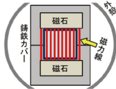
内管はステンレスの四角管で磁力が効率よく水に作用します。磁石を鑄鉄でカバーして磁力を外に漏らしません。
